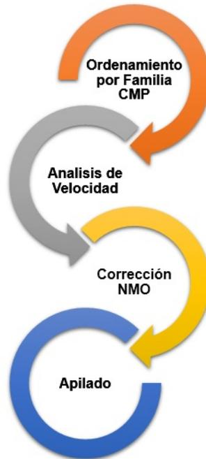
Figura 3.26. Secuencia para obtener una Sección Apilada
