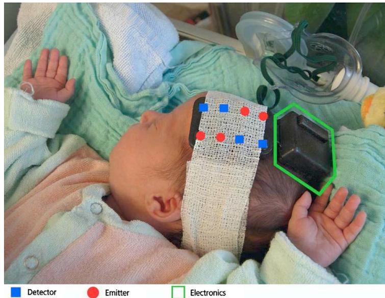
**Figura 1.4 Instrumento inalámbrico para recolectar imágenes usado en la cabeza de un bebé recién nacido, los cuadrados rojos representan los detectores mientras los círculos rojos representan la localización de las fuentes, cada uno equipado con diodos emisores en dos longitudes de onda (730 y 830 nm). El dispositivo electrónico señalado en verde tiene un dispositivo de transmisión inalámbrica que pesa unos 40gr (Wolf, 2007).**
