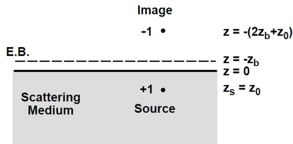
**Figura 2.11** Solución de la ecuación de difusión para un medio turbio semi infinito que se puede solucionar por el principio de imágenes. La frontera física o interface esta en  $z=0$ . Una imagen negativa de la fuente en  $z = -(z_0 + 2z_b)$  y en el punto  $z = z_0$  poseen simetría espejo con respecto a la condición de frontera cero extrapolada en  $z = -z_b$ . Tomado de (Li, 1998)
