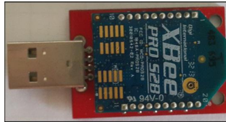
Figura 6-16 XBee Pro S2B acoplado al XBee Explorer
