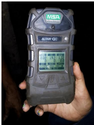
Figura 5-1 Equipo personal para la detección de gases tóxicos
