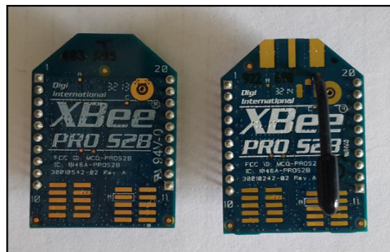
Figura 6-13 Módulo Xbee Pro S2B con antena pcb y antena
