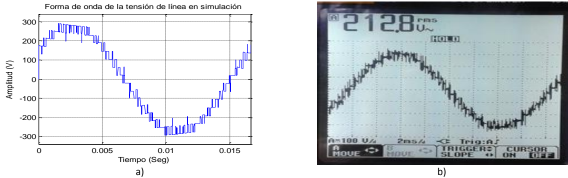
Figura 6.29. Forma de onda de la tensión de línea: a) en simulación. b) experimental
