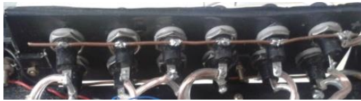
Figura.6.3.a. Conexión de los fusibles al bus de cd.b. Conexiones de los fusibles a los primeros dos puentes del convertidor
