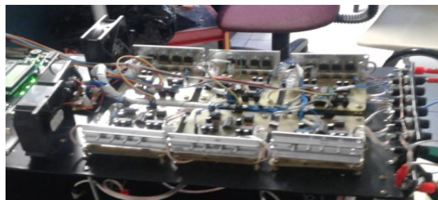
Figura 6.4. Arreglo de ventiladores para aumentar la refrigeración de los mosfets
