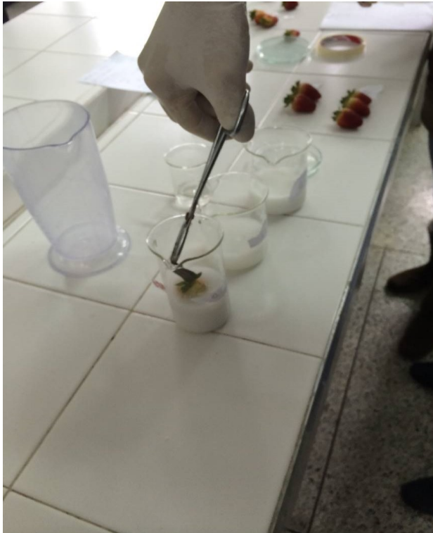
Figura 21. Sumergir la fresa para simular la aspersión del plaguicida
