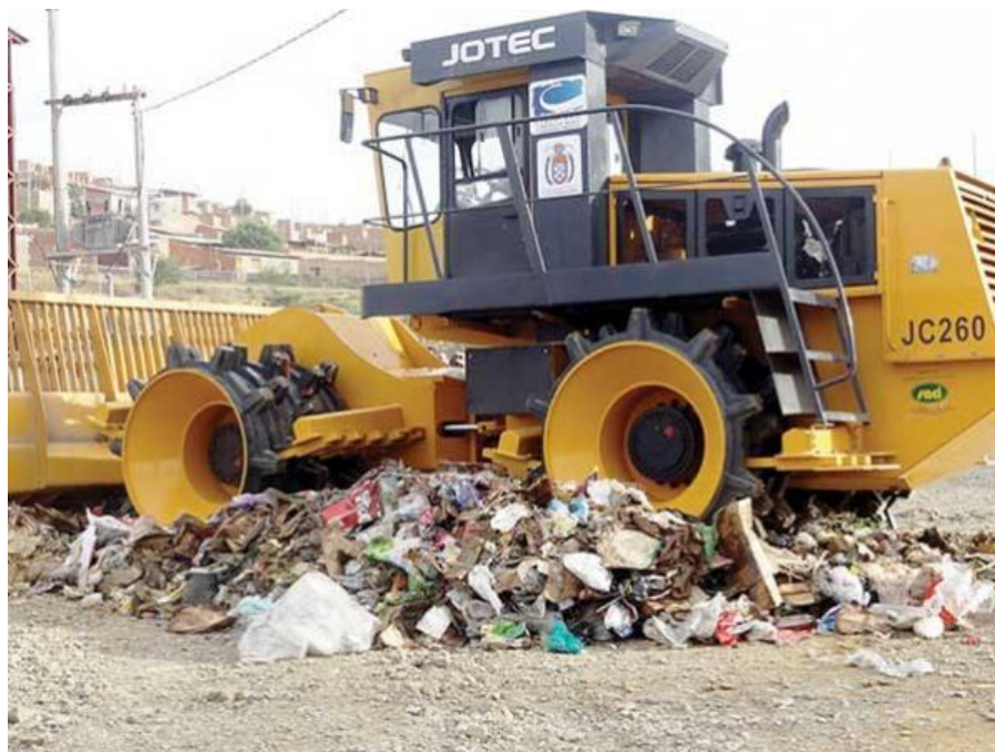
Ilustración 18 Proceso de Compactación
