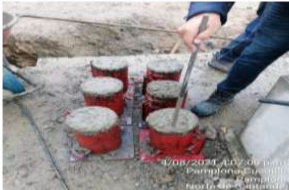
Figura 32. Ensayo de resistencia a la compresión de concreto
