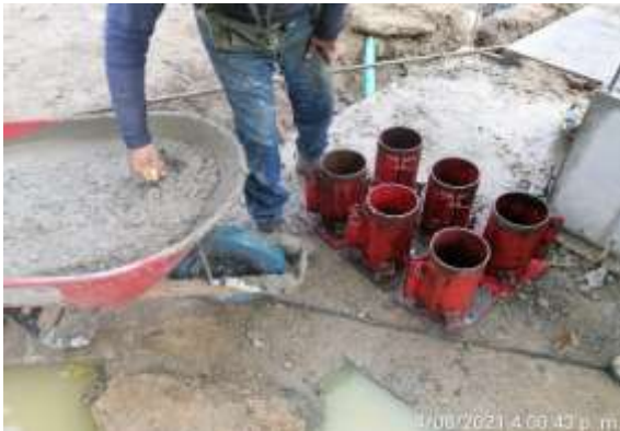
Figura 28. Vaciado de concreto por capas
