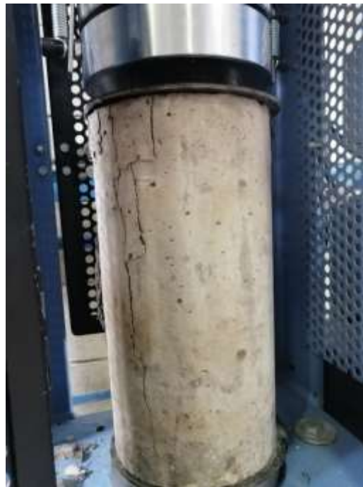
Figura 32. Ensayo de resistencia a la compresión de concreto
