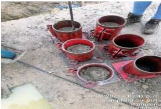
Figura 28. Vaciado de concreto por capas
