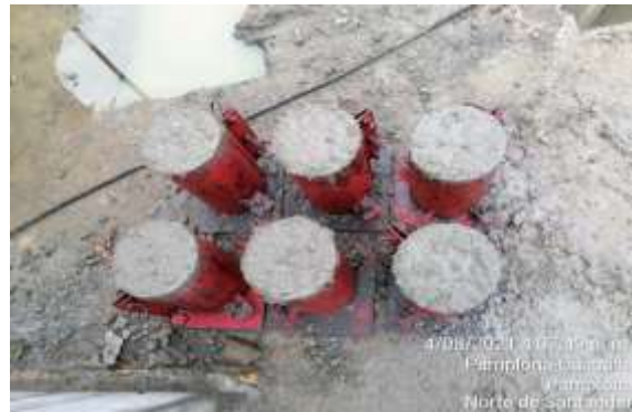
Figura 32. Ensayo de resistencia a la compresión de concreto
