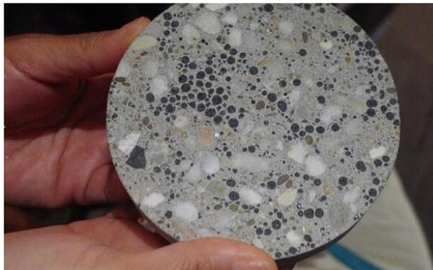
*Ilustración 9. Hormigón Autorreparable*
