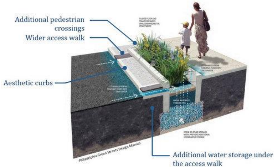
Ilustración 24 Construcción de un jardín de lluvia en la ciudad.
