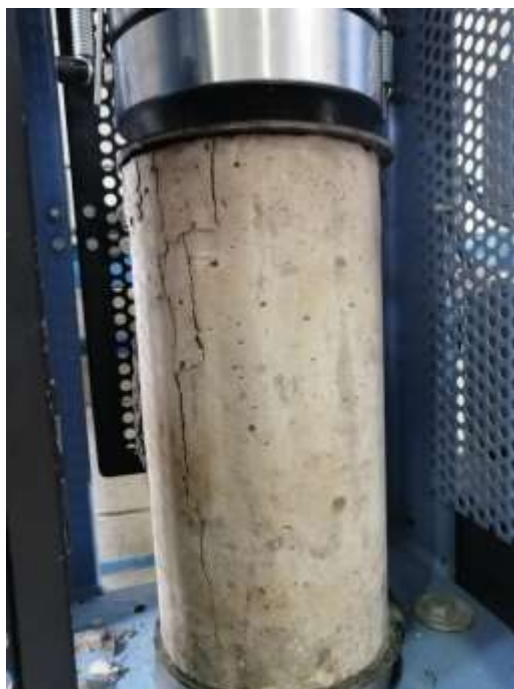
fotografía 13 Ensayo de resistencia a la compresión de concreto.
