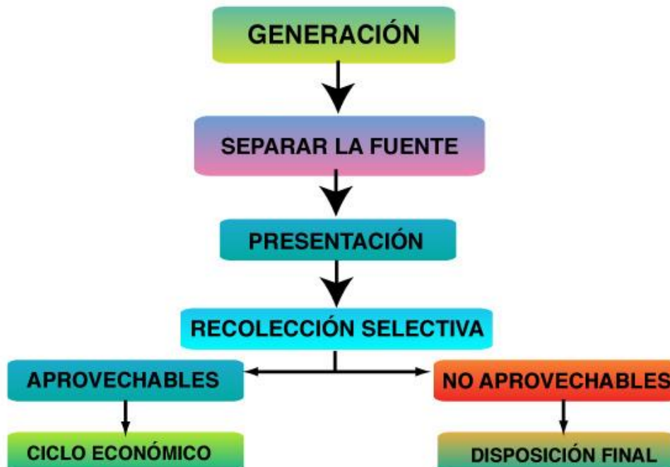
Figura 1. Elementos funcionales del tratamiento de los residuos
