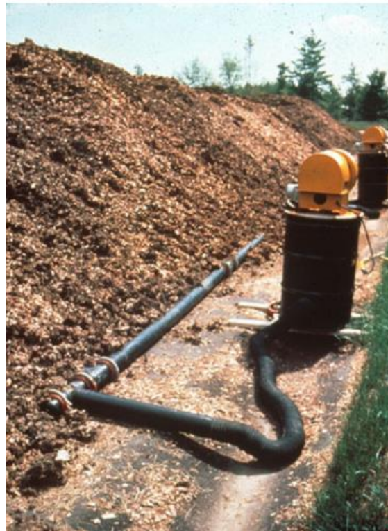
FIGURA 11. Detalle de pilas estaticas con aireacion activa.
