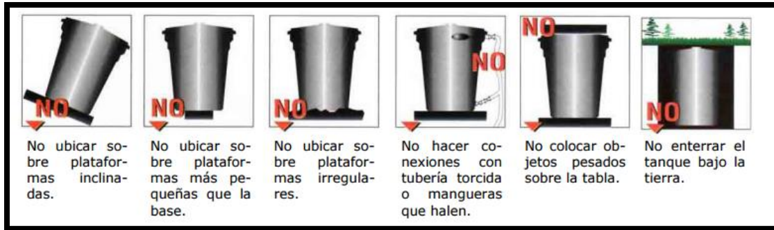
Figura 86. Errores De Instalación
