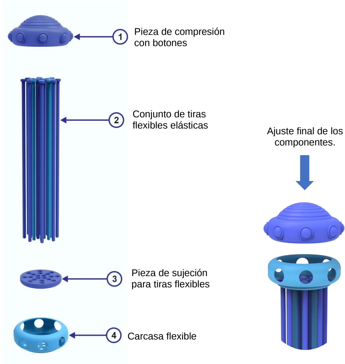
Figura 102. Despiece del elemento final.
