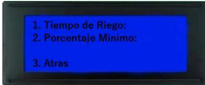
Figura 32. Pantalla 5: Configuraciones Modo Automático (Tiempo de riego/porcentaje mínimo). Autor.
