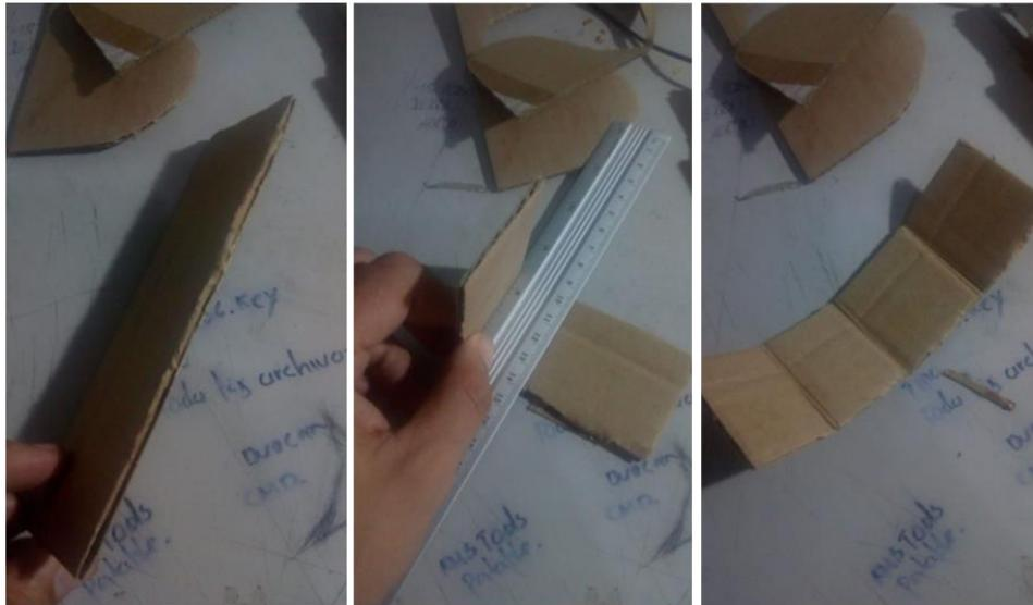
Ilustración 16 Prueba de doblado en cartón muestra #1. Fuente: Autor.
