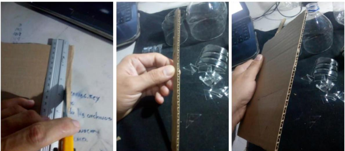
Ilustración 15 Prueba de corte recto con bisturí en cartón muestra #2. Fuente: Autor.
