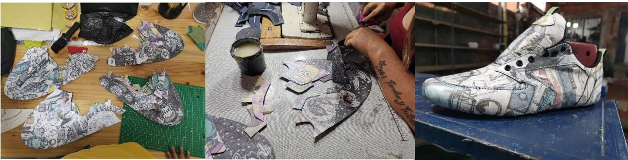
*Nota.* la imagen muestra corte, guarnecida y montaje de capella en horma .
