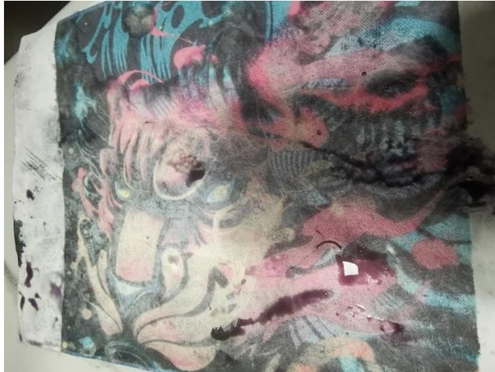
Nota. La tinta Epson regular se separa del material al contacto con el agua.
