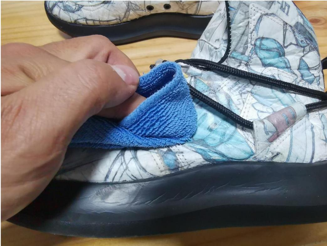
*Nota.* prueba de fricción y resistencia de tinta y material
