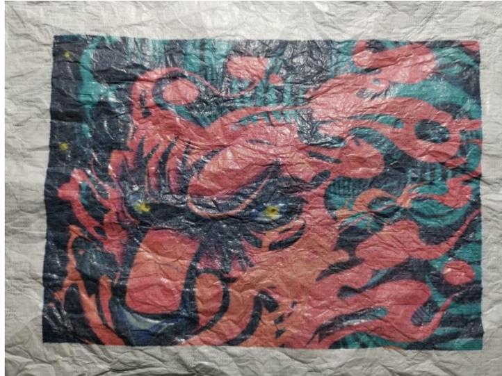
Nota. Resistencia a la fricción moderada y al corrugado, no presenta desgaste en las tintas.
