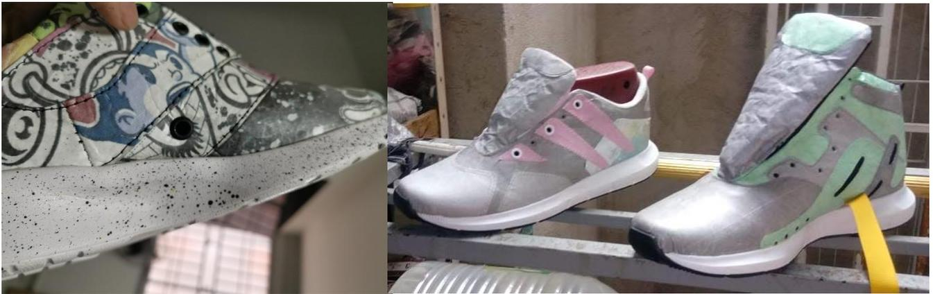
*Nota.* Sneakers terminado después del proceso de limpieza de excesos de adhesivo
