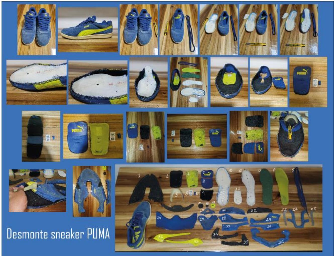
*Nota.* Desmote del calzado buscando conocer a profundidad materiales, formas de montaje que permitan el mejoramiento de la producción en el área local se destaca que de este calzado aparentemente sencillo lo integran 36 piezas.
