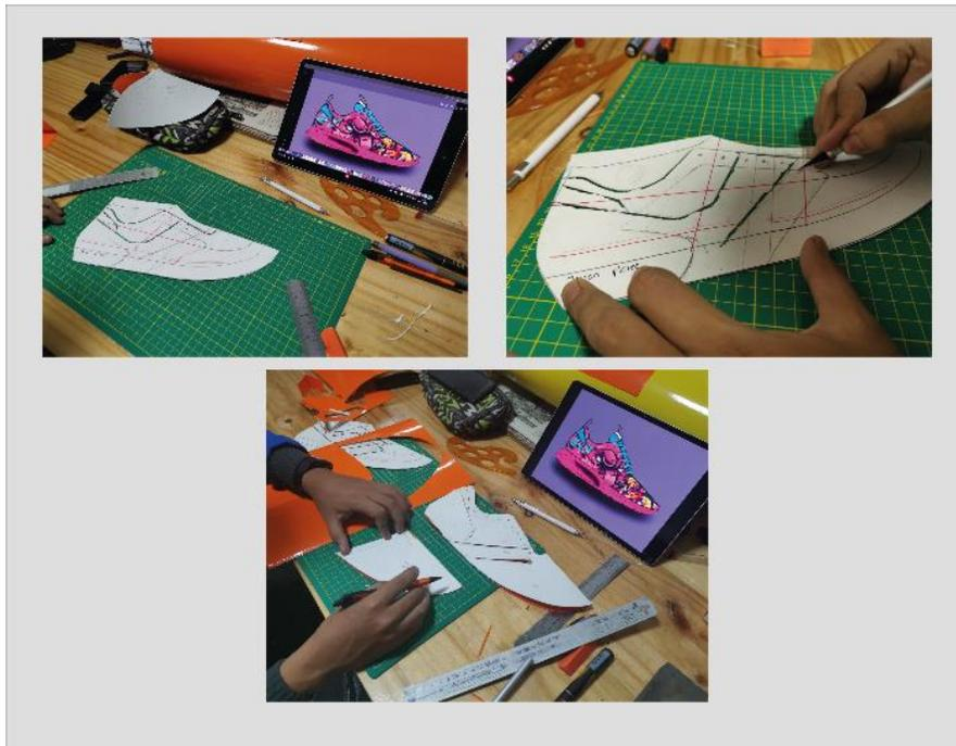
*Nota.* Dimensiones de posición de lengüeta, bandeleta, ancho de garganta, trazado de patrón, y sobreposiciones de margen de cosido.
