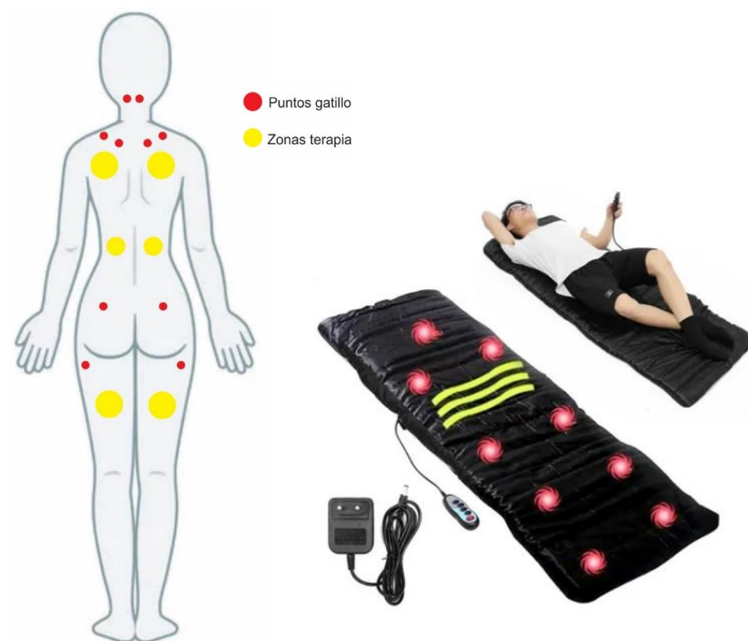
Figura 36. Distribución de los motores de vibración en el paciente comparado con el producto. Fuente: Autor y mercado libre
