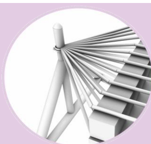
Nudo con aro para sujetarlo a la estructura
