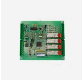
Son una superficie que se compone de pistas, huecos y vías que están hechas de un material conductor laminado sobre una base no conductora. En ellas van los levadores de energía, junto a los pulsadores. Al recibir la energía, controla todas las funciones en un circuito
