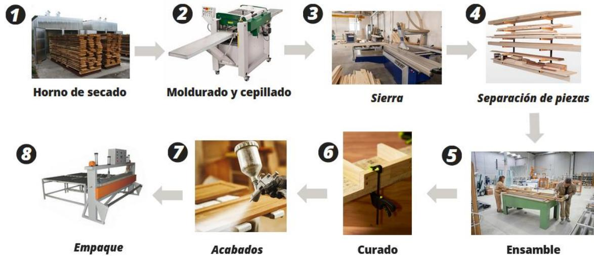
*Nota:* La presente imagen permite evidenciar el proceso que se debe llevar a cabo para la producción del producto a diseñar. Tomado de *Autor, 2022*
