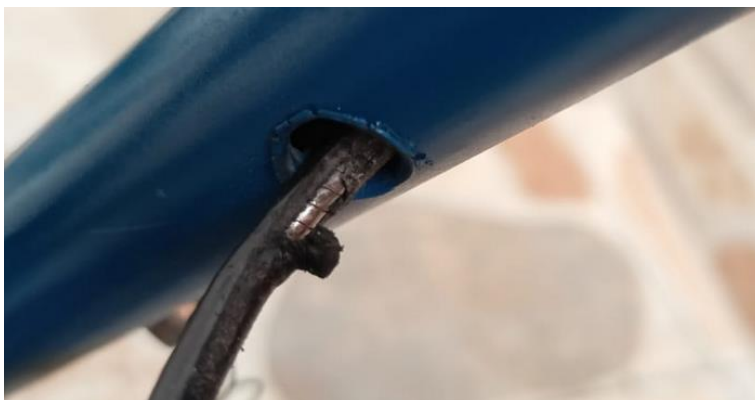
Figura 20 Daño en la manguera
