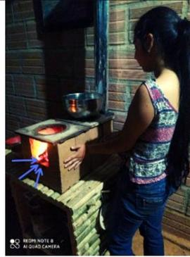
Descripción: La cámara de combustión del sistema eco-modulo el fogón ha sido diseñada mediante módulos que, al unirse entre sí, evitan el contacto directo del fuego con las manos, ya que al unir los módulos se acoplan con el fin de evitar salidas de fuego excepto por los orificios deseados y de esta manera se estaría evitando quemaduras y algunos accidentes en los usuarios.
