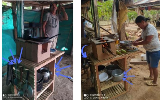
Descripción: la estufa eco-modulo el fogón, propone una estructura la cual tiene como función comportarse como stand para soportar las herramientas de la cocina, para ello cuenta con ganchos en una sus partes laterales para colgar utensilios necesarios a la hora de preparar los alimentos, elementos como cucharones, limpiones, sartenes, etc.
