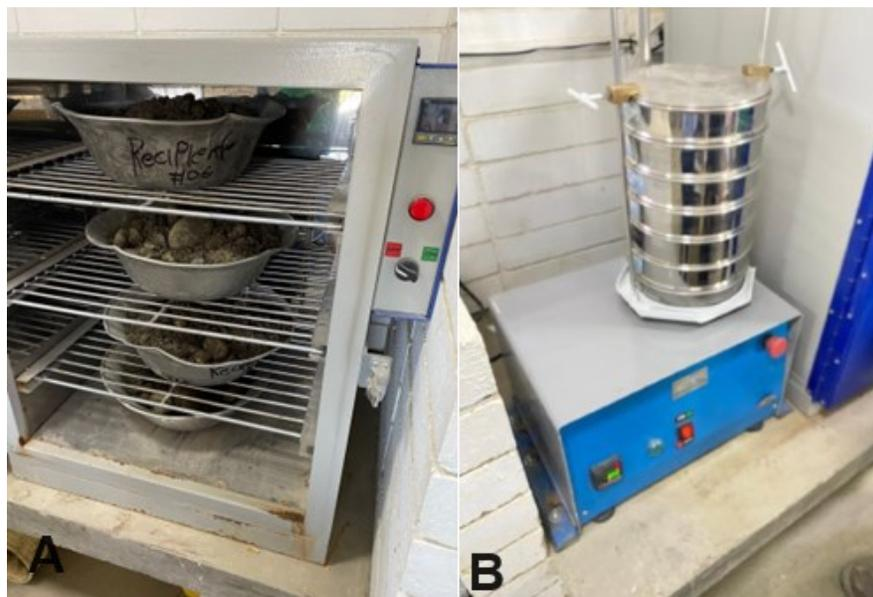
Figura 18. A) proceso de secado en el horno; B) se realiza el proceso automatizado de tamizaje para los tamices de menor tamaños para obtener mejor pérdida de muestra. Fuente: Autor.
