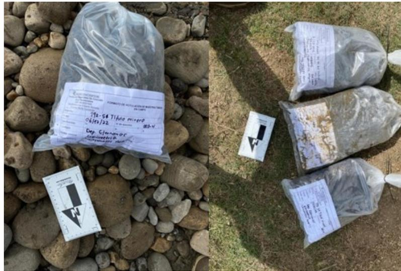
Figura 16. Proceso de cadena de custodia, donde se empaqueta la muestra, se preserva hasta ser llevada al laboratorio, rotulo donde se identifica, fecha, litología, coordenadas, posible ensayo y quien realiza el muestreo; proceso el cual se llevó a cabo para el total de las muestras. Fuente: Autor.
