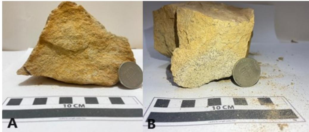
Figura 9. A) Muestra de arenita cuarzosa tomada de la estación E04-PC-SKVR. B) Muestra de sublitolarenita tomada de la estación E10-PE-SKVR. Las dos muestras son capas intercaladas de la formación grupo Guayabo.
