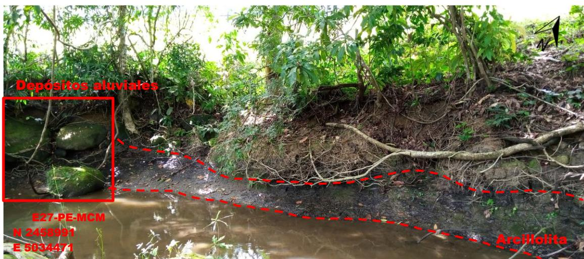
*Nota:* afloramiento ubicado sobre la quebrada la leche, donde se observa una capa de espesor medio en contacto con depósitos cuaternarios. **Fuente:** El autor
