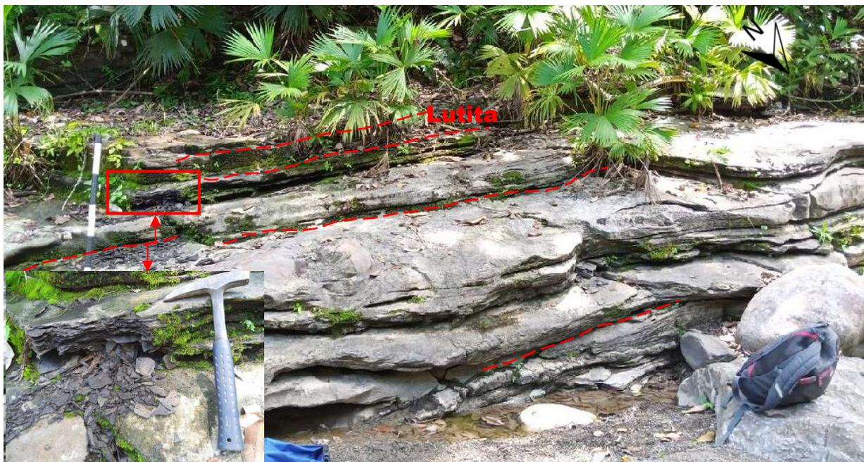
*Nota: en la fotografía se observa la intercalación de capas de caliza fosfórica, chert y lutitas, donde se aprecia los contactos difusos, semi-ondulados de las litologías y el fracturamiento en laja de las lutitas. Fuente: El autor.*
