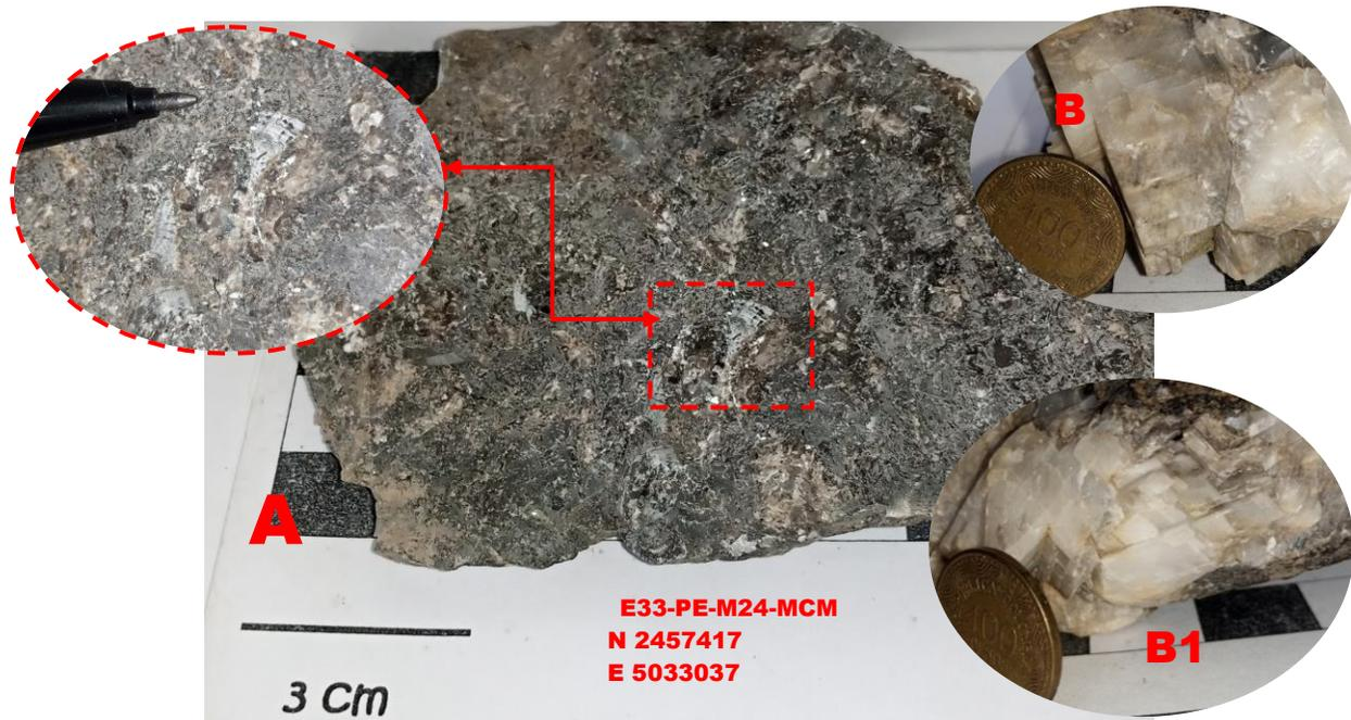
**Nota:** **Figura A**, caliza tipo Packstone, donde es posible observar la presencia de bioclastos; en la **Figura B y B1** se muestra la calcita de color blanco amarillento. **Fuente:** El autor.
