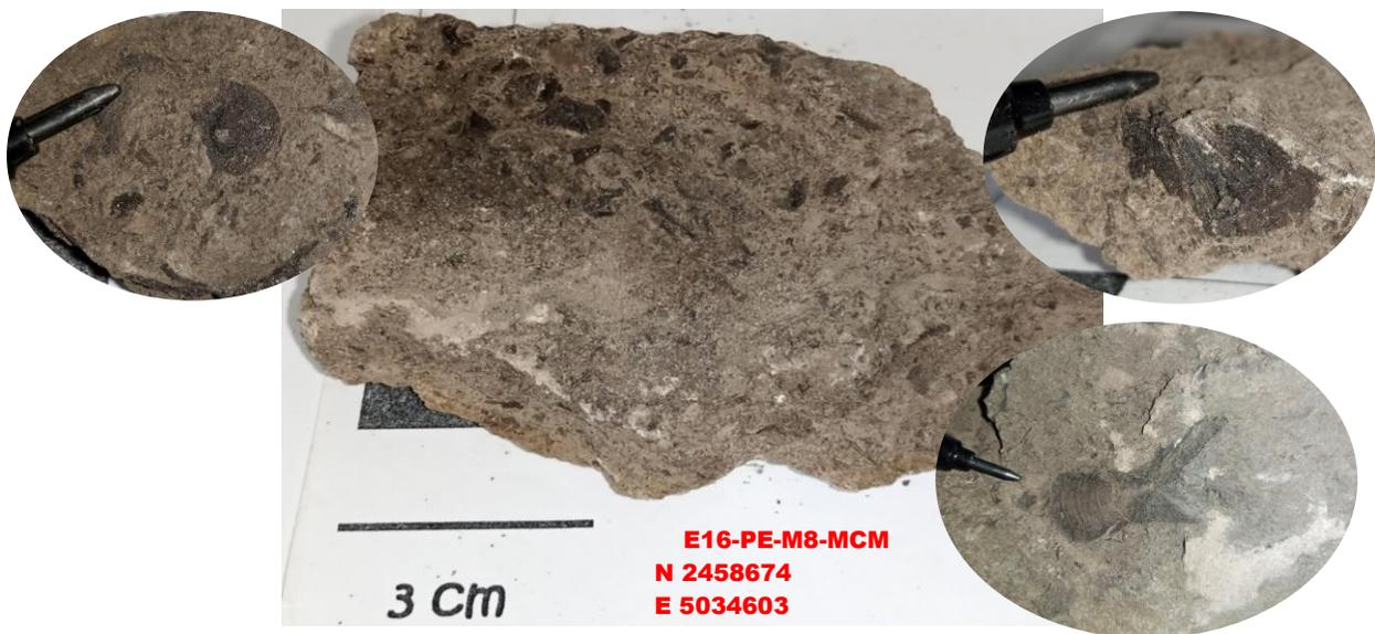
*Nota: Muestra de roca con restos de bioclastos que son reemplazados por minerales fosfáticos. Fuente: EL autor.*
