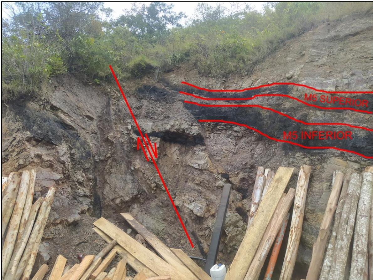
Nota. Fotografía donde se evidencia el desplazamiento de M5 debido a la falla de tipo normal San Tomas I. Fuente: El autor
