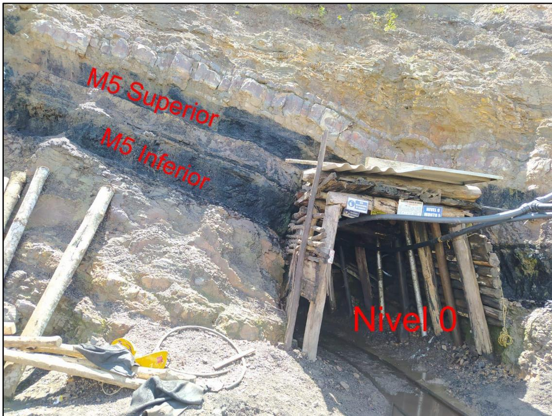
Nota. Fotografía de la labor de extracción Nivel 0, donde se observa la diferenciación de M5 inferior y M5 superior. Fuente: El Autor.
