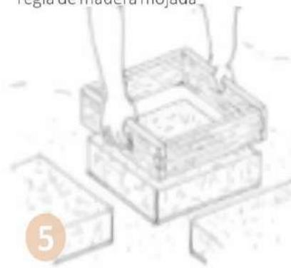
Figura 2.2.7.3.2.2 preparación y armado del adobe
