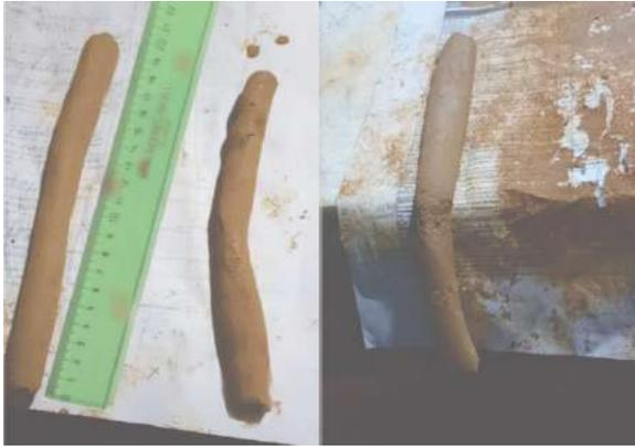
Figura 3.4.4.1: pruebas del rollito
