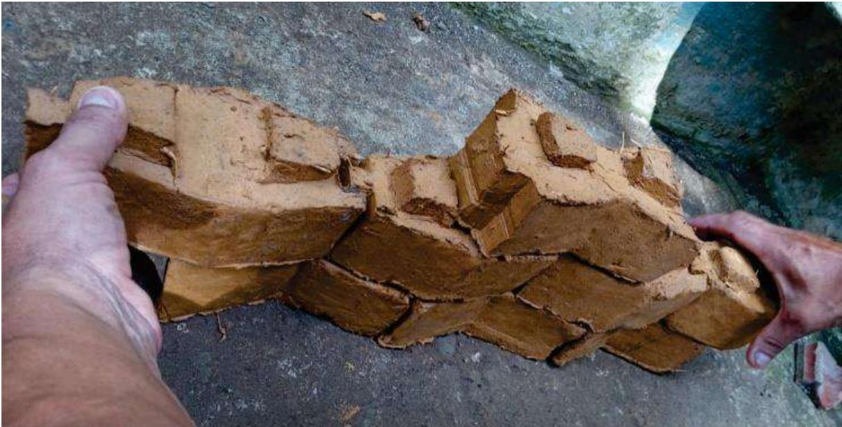
*Figura anexo 9 módulos del diseño de las unidades constructivas a escala 1:2. Representación del armado de muro*
