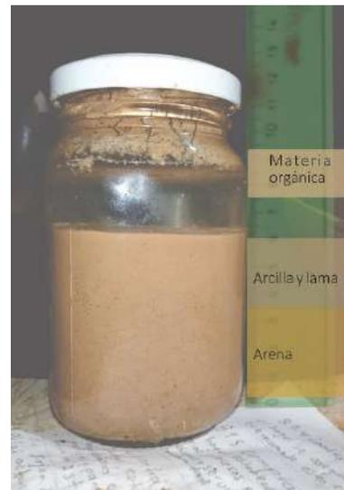
Figura 3.4.4: prueba de sedimentación de la tierra obtenida para la muestra de adobe
