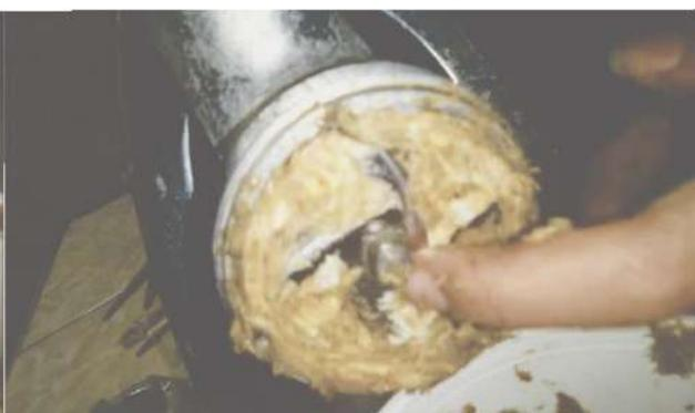
Figura 3.4.1.6 fruto molino compactado en molino por valor de fibra
