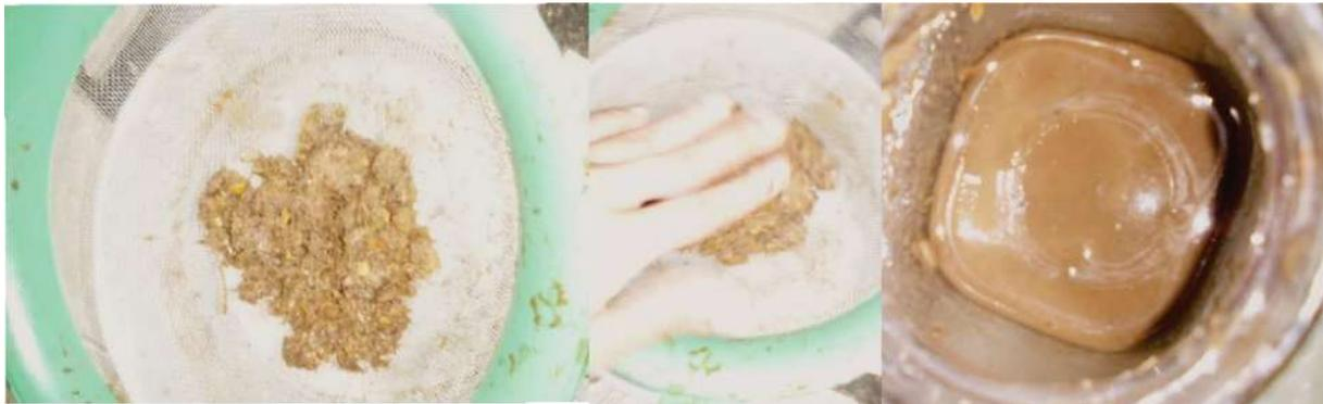
*Figura 3.4.2.19: tamizado para extracción del aglutinante después de cocción*
