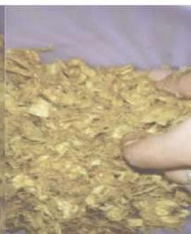
Figura 3.4.1.7 resultado de fibra viscosa después de molienda
