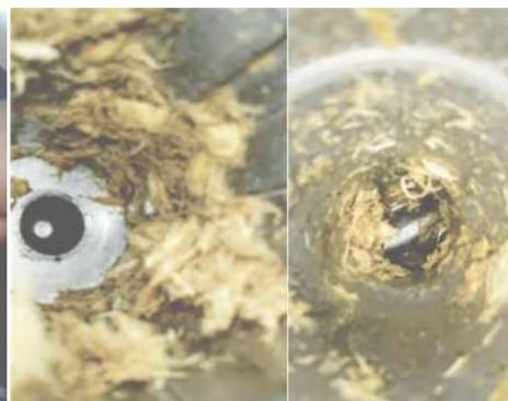
Figura 3.4.1.5: residuos de fibra al interior del molino
