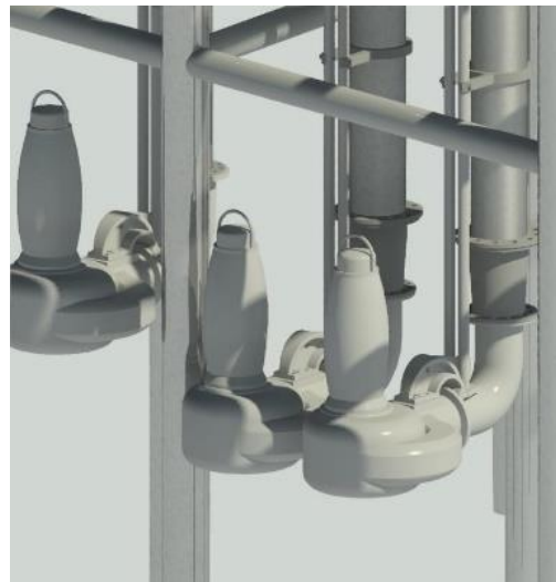
Ilustración 29 Modelado 3D bomba instalada y abrazaderas
