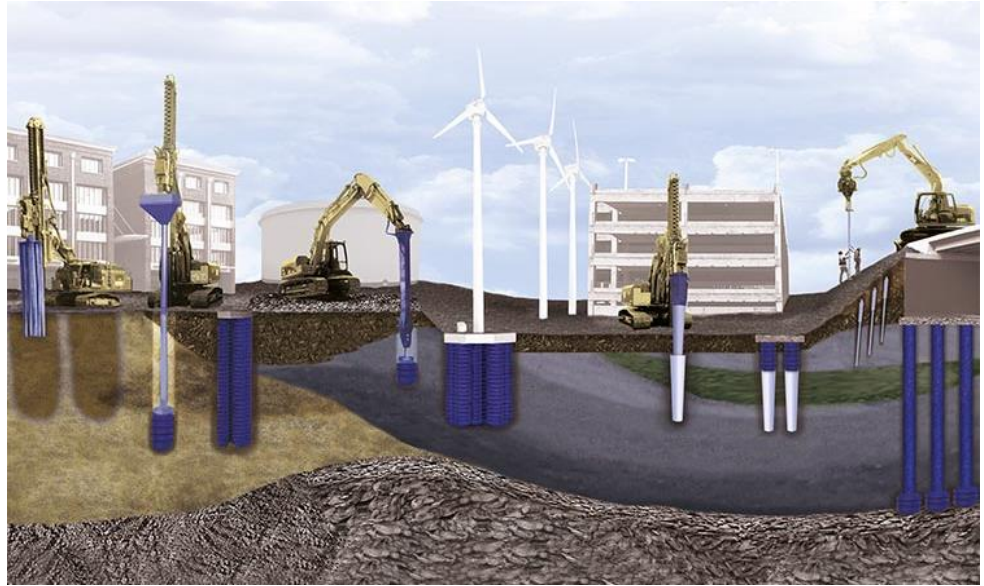
Ilustración 11. Geopier: Columnas de grava compactada
