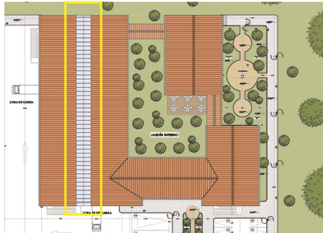
Ilustración 71. Localización de paneles solares en sobrecubierta.
