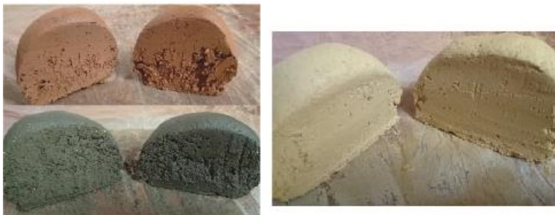
Imagen 42- 47: Prueba de brillo. Realización propia del autor. (2020)
