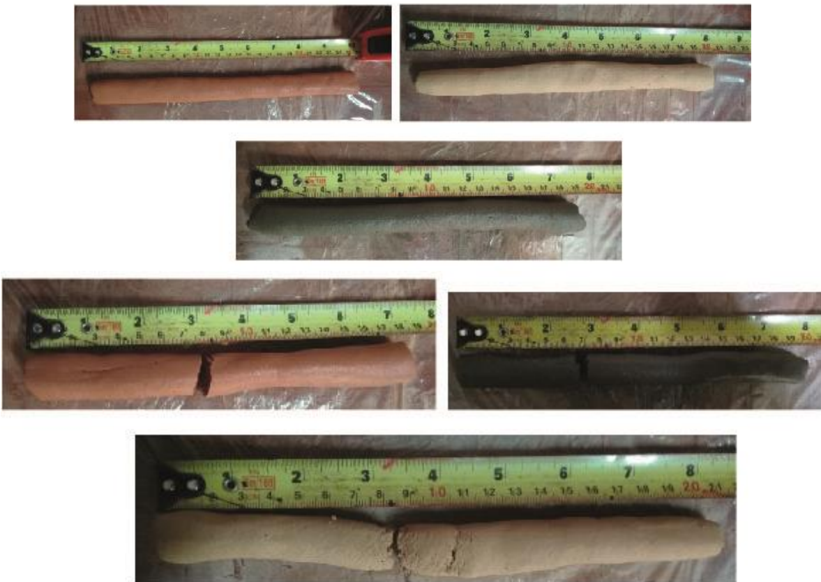
Imagen 41- 47: Prueba de plasticidad. Realización propia del autor. (2020)
