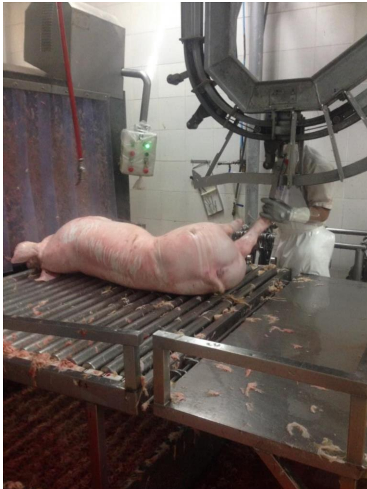
Figura 41 izado de porcino al riel
