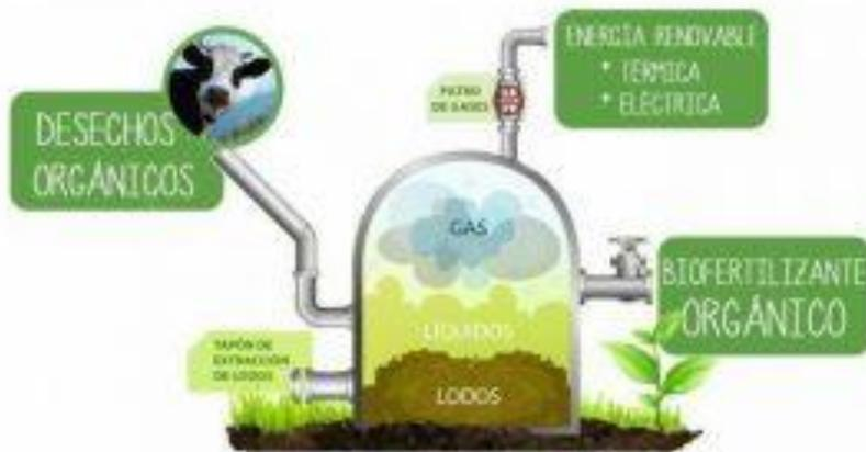
Ilustración 48 Funcionamiento de un Biodigestor
