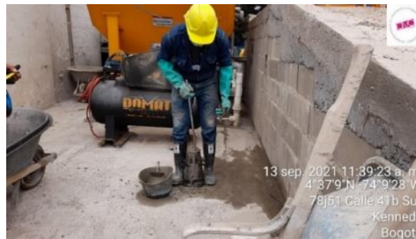
Figure 42 Toma de asentamiento, cono de Abrams. Fuente: Propia.
