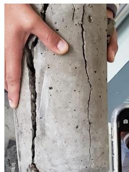
*Ilustración 31 Registro fotográfico del ensayo resistencia a la compresión del concreto, dosificación 1:2:3*
