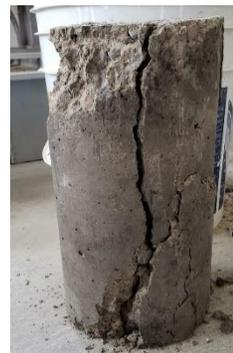
*Ilustración 32 Registro fotográfico del ensayo resistencia a la compresión del concreto, dosificación 1:2:2*
