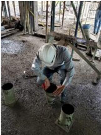
*Ilustración 19 Referencia fotográfica dosificación 1:2:3, ensayo del cono de Abraham.*
