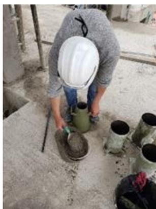
*Ilustración 22 Referencia fotográfica dosificación 1:2:2, ensayo del cono de Abraham.*
