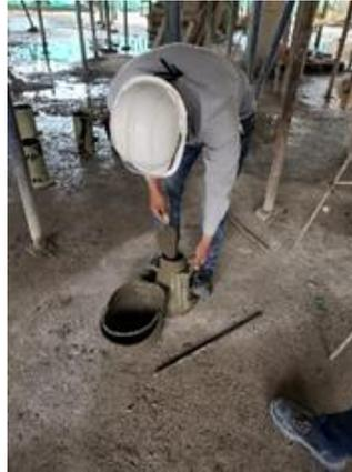
*Ilustración 20 Referencia fotográfica dosificación 1:2:3, ensayo del cono de Abraham.*
