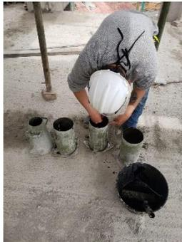
*Ilustración 28 Registro fotográfico del ensayo resistencia a la compresión del concreto, dosificación 1:2:2*
