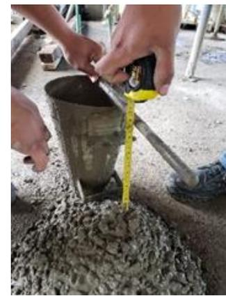
*Ilustración 21 Referencia fotográfica dosificación 1:2:3, ensayo del cono de Abraham.*
