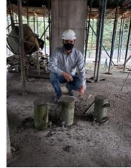
*Ilustración 27 Registro fotográfico del ensayo resistencia a la compresión del concreto, dosificación 1:2:3*
