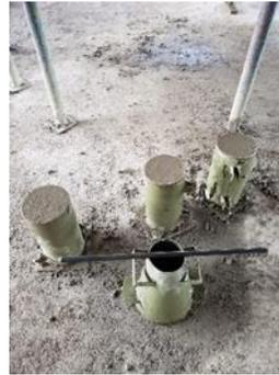
*Ilustración 26 Registro fotográfico del ensayo resistencia a la compresión del concreto, dosificación 1:2:3*
