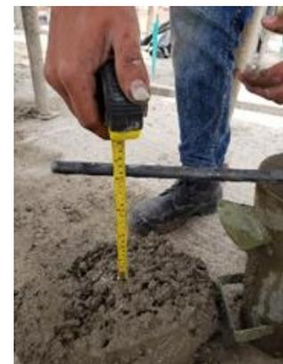
*Ilustración 24 Referencia fotográfica dosificación 1:2:2, ensayo del cono de Abraham.*
