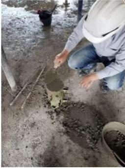
*Ilustración 25 Registro fotográfico del ensayo resistencia a la compresión del concreto, dosificación 1:2:3*
