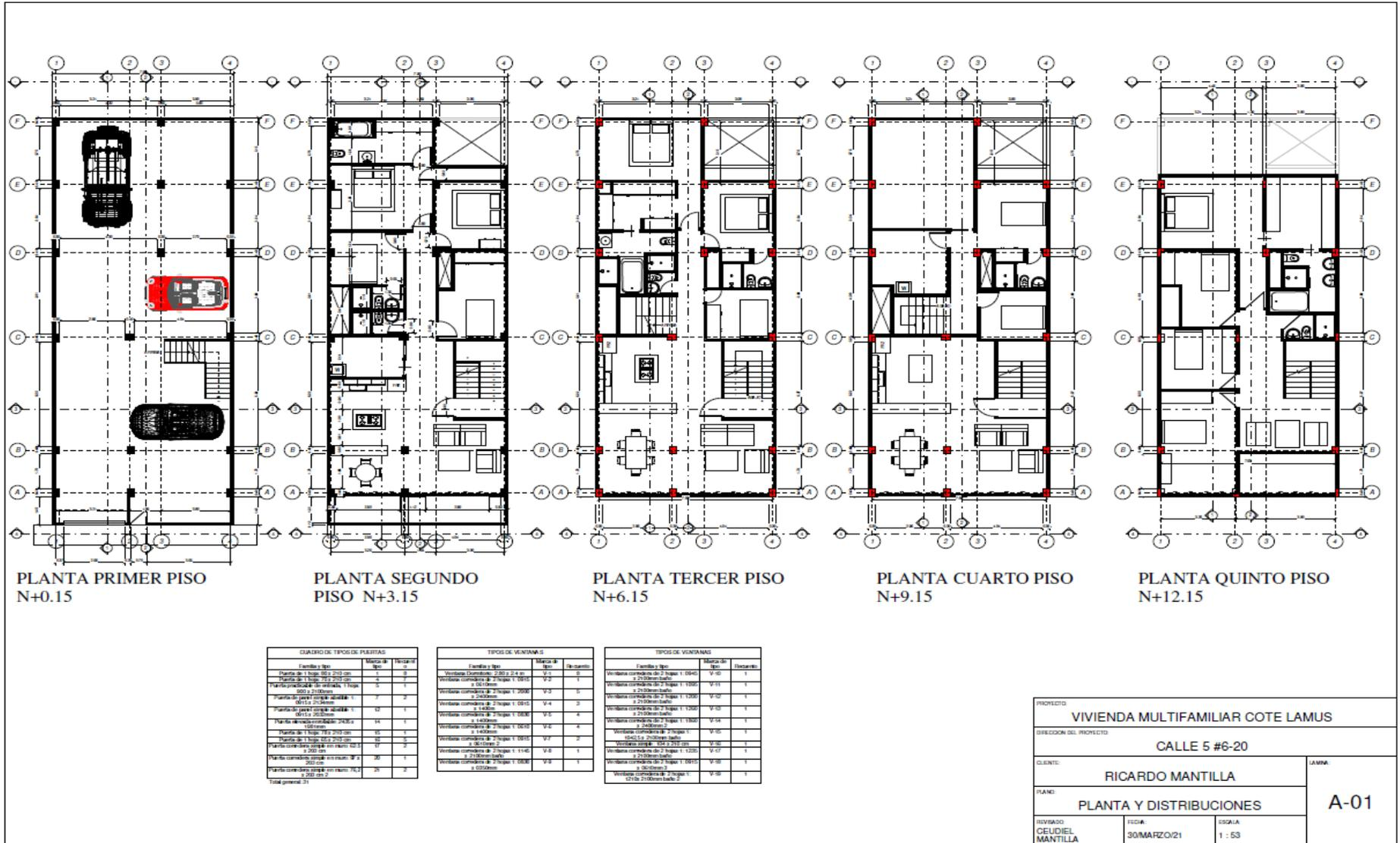
Ilustración 41 Vista en planta arquitectónicas Cote lamus. Diseño: Revit 2021
