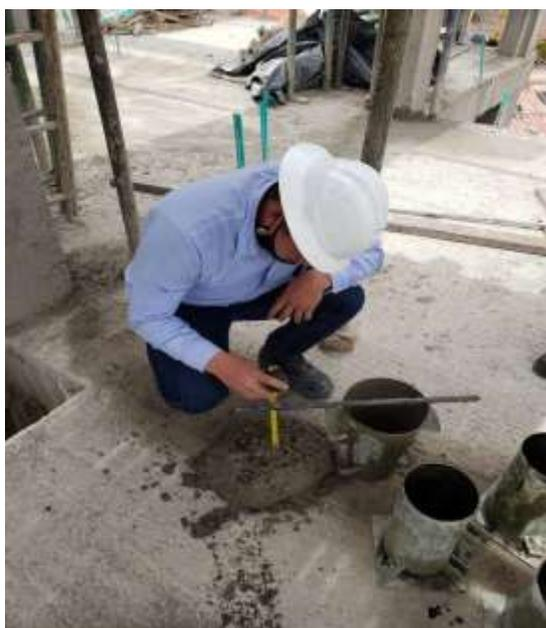
*Ilustración 16 Ensayo de asentamiento Cono de Slump Dosificación 1:2:2*
