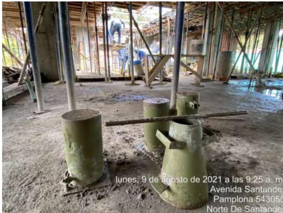
*Ilustración 22 Cilindros de concreto y cono de slump.*
