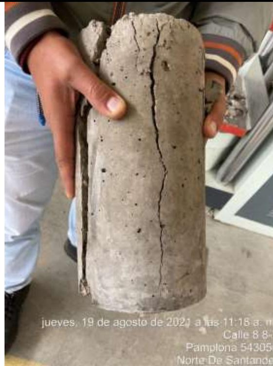
*Ilustración 18 Falla tipo 2 según Norma Invas E-410 13*
