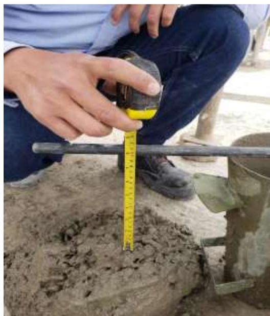
*Ilustración 17 Ensayo de asentamiento Cono de Slump Dosificación 1:2:2*
