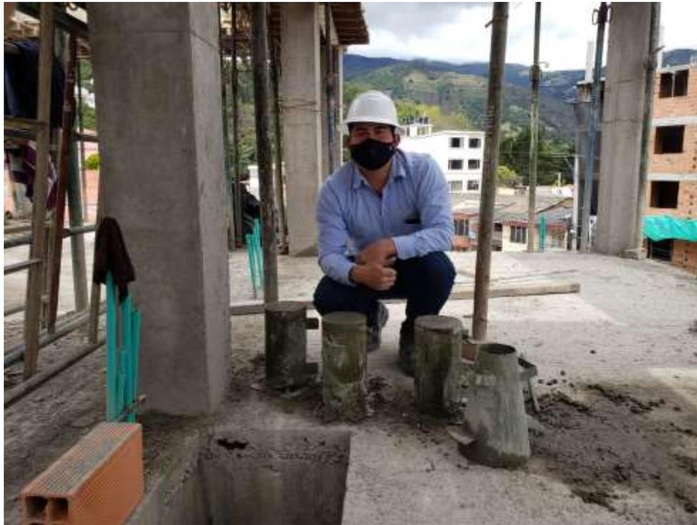
*Ilustración 21 Toma de muestras Cilindros de concreto.*
