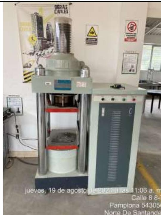
*Ilustración 19 Maquina ensayo presión YF STSP-1*
