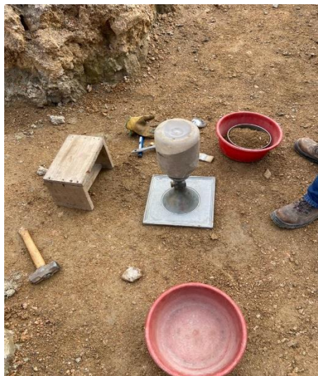
Ilustración 46. Ensayo cono de arena, fuente: Cifuentes Mafla
