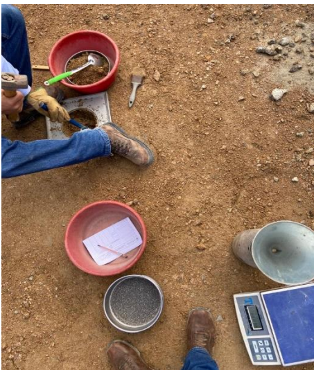
Ilustración 45. Ensayo cono de arena, fuente: Cifuentes Mafla
