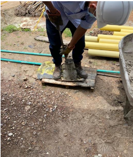
Ilustración 48. retiro de burbujas de aire, fuente: Cifuentes Mafla
