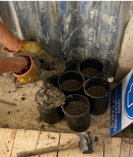
Ilustración 51. Ensayo compresión, fuente: Cifuentes Mafla
