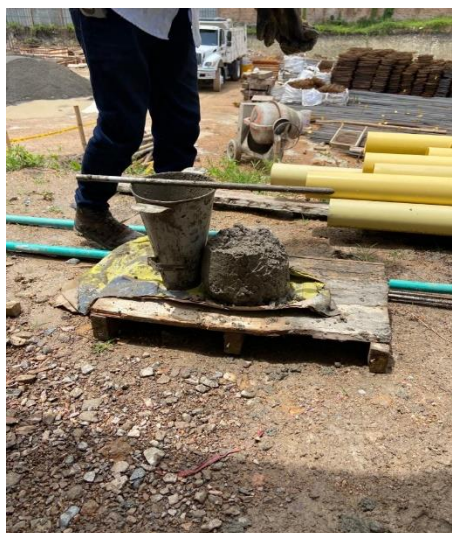
Ilustración 49. Ensayo de fluidez, fuente: Cifuentes Mafla
