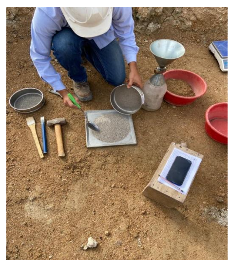
Ilustración 47. Ensayo cono de arena, fuente: Cifuentes Mafla
