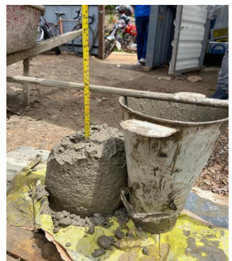
Ilustración 50. Medición de las pulgadas de asentamiento, fuente: Cifuentes Mafla
