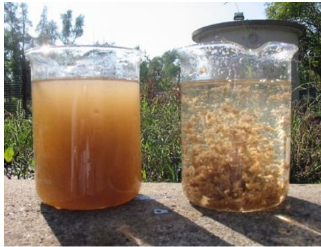
Ilustración 3: Separación del sistema de coagulación-floculación.
