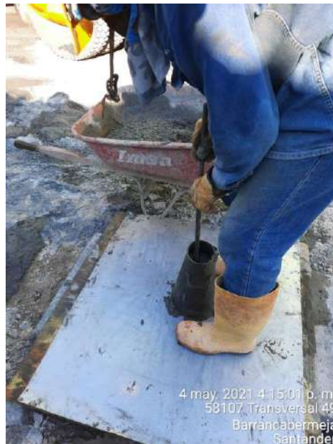
Ilustración 20. Preparación de prueba para análisis de SLUMP según norma NTC 673. Fuente: Propia
